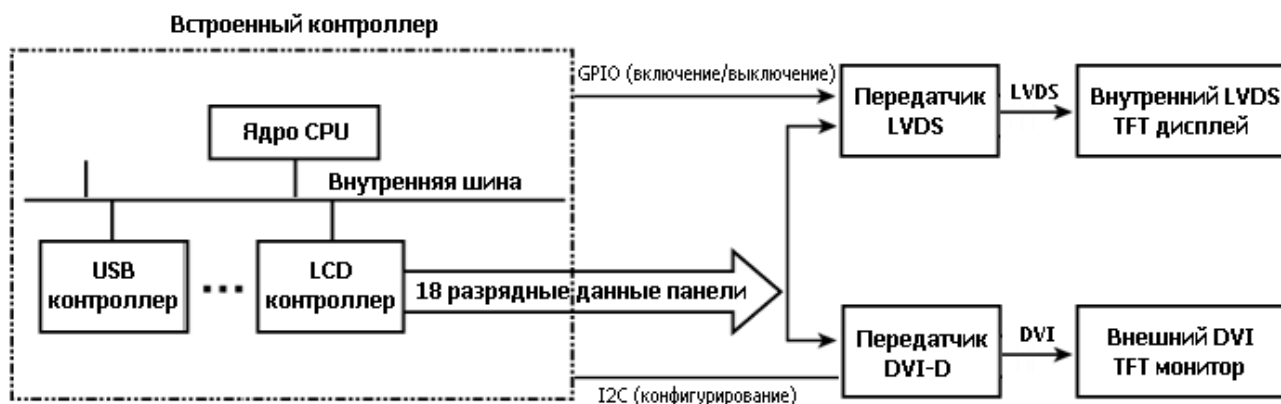
Рисунок 12.3. Подключение LVDS и DVI на встроенной системе.
